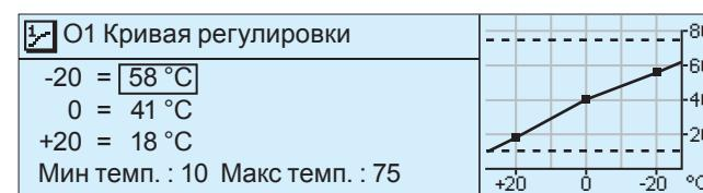
При удерживании в нажатом положении кнопки ОК Вы можете корректировать установочные точки температуры наружного воздуха, находящиеся между показателями температуры +20 и -20°C (установочными точками по заводским уставкам являются значения +10, 0 и -10°C).
