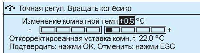
При использовании комнатного датчика функция точной настройки позволяет напрямую влиять на расчётное уставочное значение температуры воздуха в помещении в диапазоне  $+4^{\circ}\text{C}$ .
