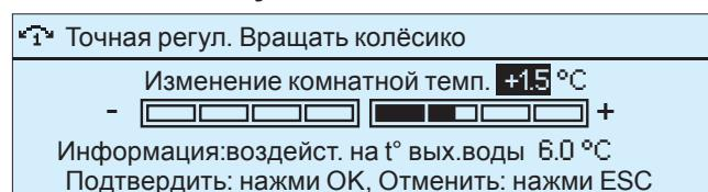
В случае если комнатный датчик не подключён к системе, функция точной настройки обеспечивает параллельное смещение кривой автоматики, при этом крутизна кривой не изменяется. Нижний ряд показывает степень влияния функции точной настройки на температуру воды в прямом контуре.
