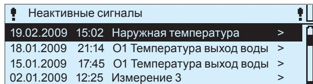
Данные по деактивированным аварийным сигналам сохраняются в архиве аварийных сигналов. На экране высвечивается информация о причине возникновения сигнала, объекте его возникновения и времени деактивации (например, 19.09.2009 в 15:55:10). На экране высвечиваются 10 из последних деактивированных аварийных сигналов.
