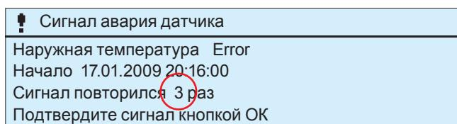
В случае неоднократного поступления на контроллер аварийного сигнала по одной и той же причине на экране указывается количество аварийных сигналов, поступивших на контроллер по одной и той же неисправности.
