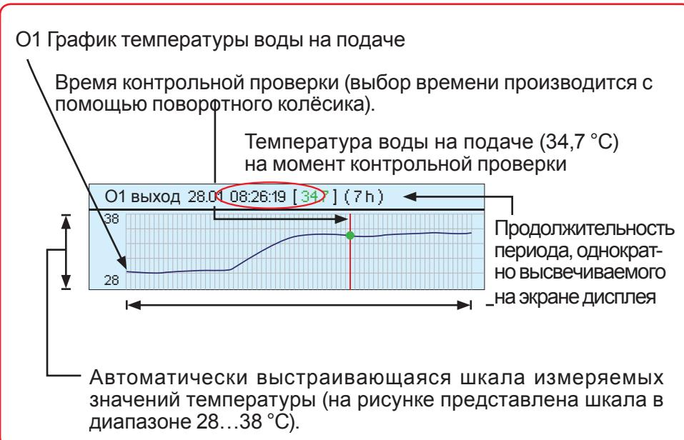
Для пользователя контроллером EH-800 предусмотрена возможность загрузки файла тренда на персональный компьютер с последующим просмотром тренда в графическом изображении на экране монитора. Просмотр тренда в виде файла может обеспечиваться в графическом режиме с помощью программы Ouman Trend. Загрузку программы можно выполнить на сайте [www.ouman.fi](http://www.ouman.fi)
