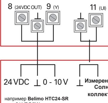
Подключение двигателя подпиточного насоса к расширительному модулю EXU-800
