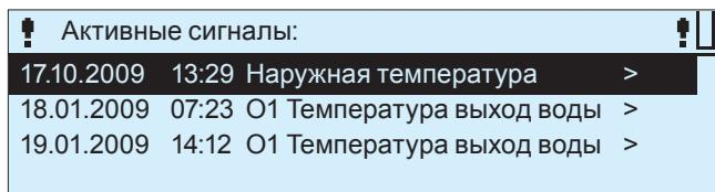
Каждый из активных аварийных сигналов отображается в собственной строке меню. На экране имеется возможность считывания времени активации аварийного сигнала. Дополнительные данные по аварийному сигналу можно вывести на экран нажатием на OK в строке данного сигнала.
