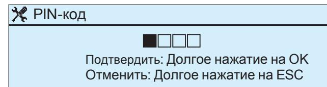
**Код устройства:** Контроллеру может быть присвоен код устройства, который используется в качестве пароля и адресных данных устройства. Код устройства может задаваться произвольно. При установке связи с контроллером посредством мобильного телефона код устройства (при его наличии) необходимо всегда вводить перед ключевым словом. При вводе кода необходимо учитывать нижний и верхний регистр символов. Для удаления кода устройства необходимо оставить поле для его ввода пустым.
