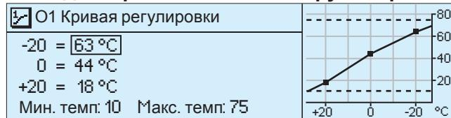
В контроллер заранее запрограммированы кривые графиков регулирования и установочные параметры для различных режимов отопления. Как правило, необходимости внесения изменений в предварительные заводские уставки не имеется.
