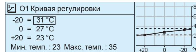
**Установка минимального предельного значения температуры воды на подаче обеспечивает работу режимов комфорта тепла и влагоудаления влажных помещений в летний период.**
