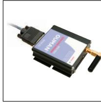
Модем может подключаться к контроллеру напрямую через специальный разъём модема либо через расширительный модуль. Питание модема также может обеспечиваться через расширительный модуль.
