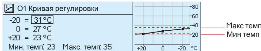
Установочный параметр минимально допустимой температуры воды на подаче позволяет обеспечить работу комфорtnого обогрева и функции влагоудаления также в летний период.
