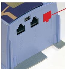
Подсоедините кабель Ethernet к разъёму контроллера EH-800 и произведите повторное включение контроллера.
