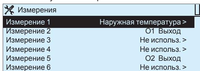
3. Выберите эксплуатационное назначение измерительного канала (дополнительные данные по эксплуатационному назначению представлены на следующей странице). Нажмите OK.
