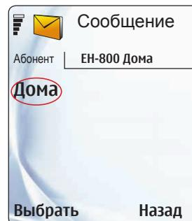
Управление в режиме «Дома» используется в случае, когда контроллер переведён в режим понижения температуры по недельной/суточной программе или по календарю нестандартного графика и пользователь желает обойти действующую команду управления на понижение температуры. Команда управления «Дома» обеспечит переключение контроллера в режим стандартного температурного режима.
