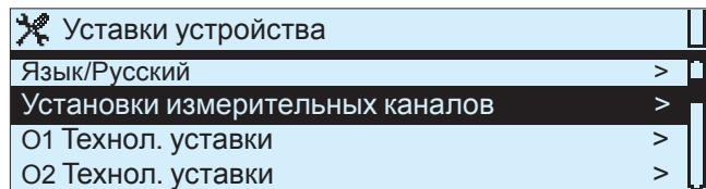
В базовой комплектации в контроллере ЕН-800 предусмотрено наличие 4-х измерительных каналов. При подключении к контроллеру расширительного модуля количество измерительных каналов контроллера возрастает до 6.
