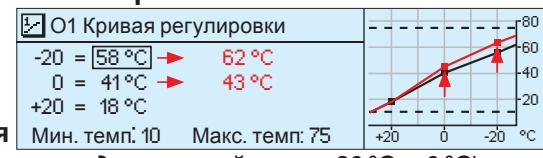
При повышении температуры воздуха в помещении следует уменьшить крутизну кривой графика регулирования (установите более низкие параметры для значений температуры -20 °C и 0 °C).
