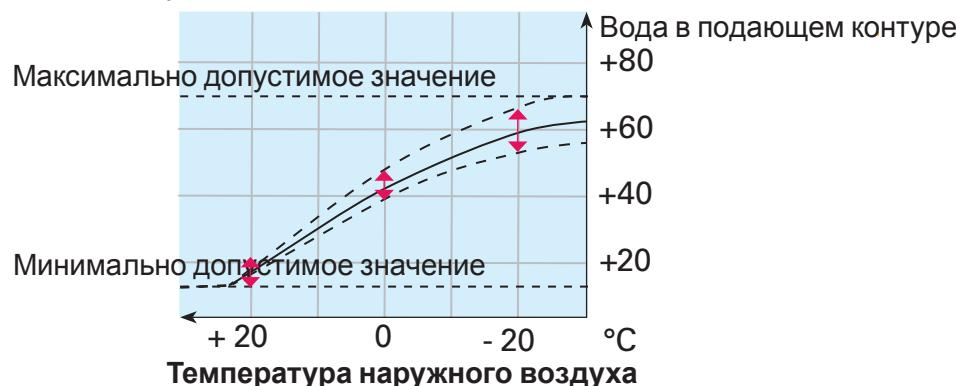
**Кривая регулирования по 3-м точкам:** Температура воды на подаче устанавливается для трёх показателей температуры наружного воздуха: -20°C, 0°C и +20°C. Контроллер блокирует попытки установки кривой некорректной конфигурации, обеспечивая автоматическую корректировку кривой.
