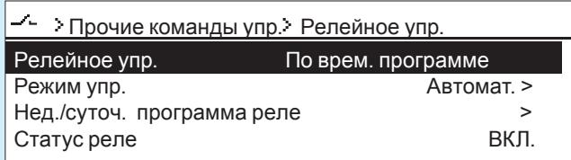
Изменение статуса реле обеспечивается по установленной недельной/суточной программе. На дисплее контроллера высвечивается текущий статус функции управления реле. Недельная/суточная программа управления реле находится также в списке временных программ. Установите время срабатывания функции релейного управления. Выберите статус, в который реле должно перейти в установленное время. После этого выберите дни недели для работы релейного управления.
