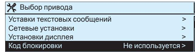
При использовании кода блокировки пользователь имеет возможность считывания данных с контроллера при его нахождении в режиме блокировки, но не имеет возможности изменения уставочных значений контроллера. Код блокировки рекомендуется к использованию, например, при нахождении контроллера в помещении общего пользования и его доступности для изменения уставок любым лицом. Код блокировки исключает несанкционированный доступ к уставкам контроллера.
